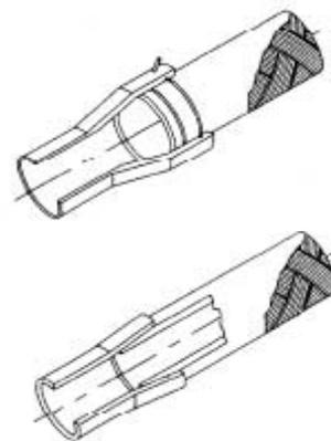
à jonction mécanique Key-Lock® ou collée Taper/Taper pour application industrielle générale
